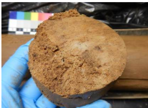
Fig. 20. FS01, 2,00 ÷ 2,40 m – weak clayey alluvial layer
