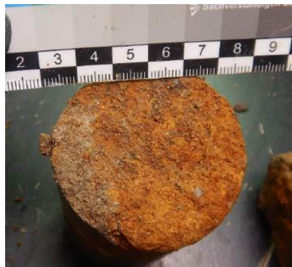
Fig. 17. FS07+DPH, 1,50 ÷ 1,70 m – clayey alluvial layer
