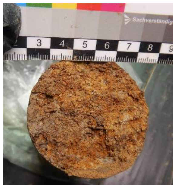
Fig. 15. FS05+DPH, 1,50 ÷ 1,70 m – clayey alluvial layer
