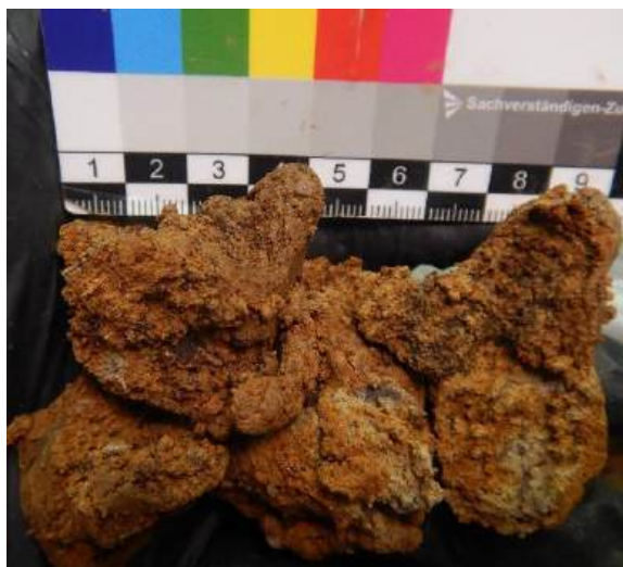
Fig. 16. FS06+DPH, 1,70 ÷ 2,00 m – clayey alluvial layer
