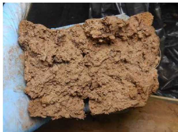
Fig. 21. FS03, 3,00 ÷ 3,40 m – weak clayey alluvial layer
