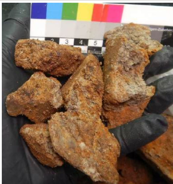
Fig. 14. FS04+DPH, 1,30 ÷ 1,50 m – clayey alluvial layer
